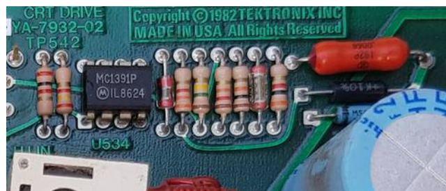
Abbildung 29: Kondensator C521 (schwarz, rechts) mit Pluspol an Masse
