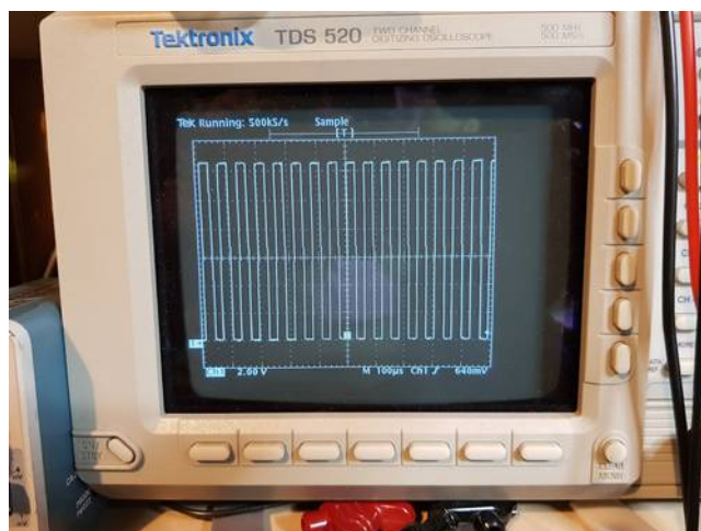
Abbildung 26: Ausgangssignal LM1391 Testaufbau
