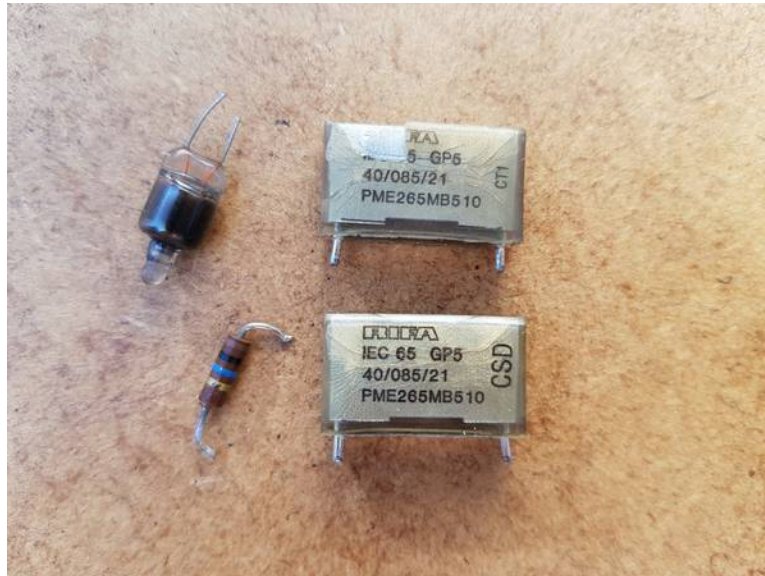
Abbildung 13: Ausbeute offensichtlich defekter Bauteile im Netzteil
