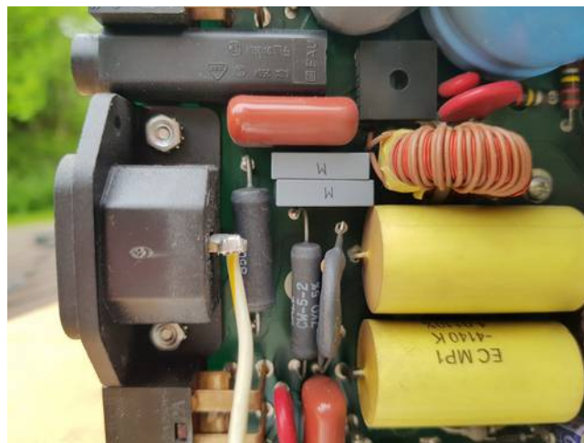
Abbildung 14: Ersatz durch Kemet MKP Y2
