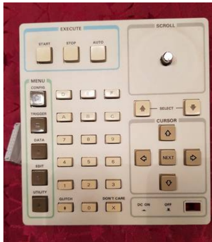
Abbildung 2: Angeschmutzte Tastatur mit klebrigen Tasten
