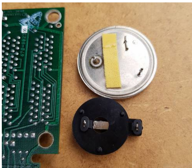
Abbildung 31: Abgebrochenes Beinchen
