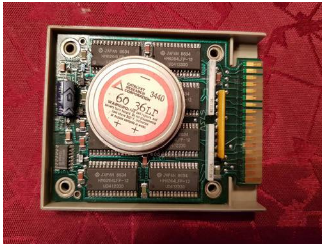
Abbildung 30: 12RS02 64K RAMPAK mit 3440-Zelle
