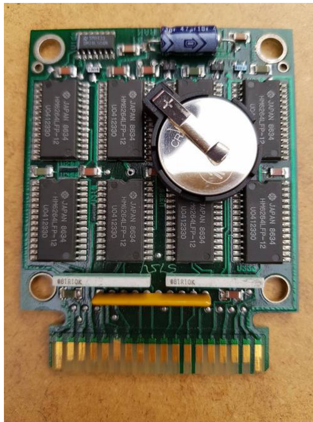
Abbildung 32: Zellenersatz im Speichermodul
